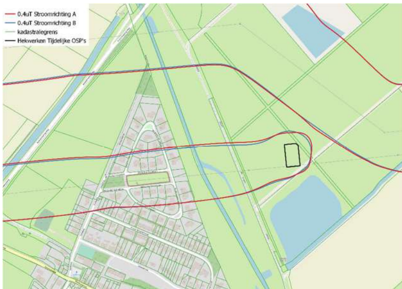
Figuur 27 0,4 μT-contour tijdelijke 150 kV OSP Mast 22
