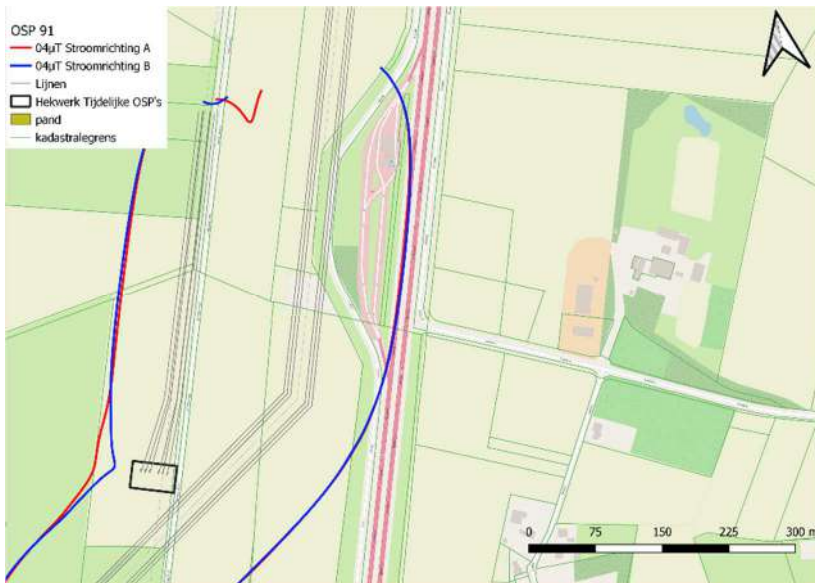
Figuur 23 0,4 μT-contour tijdelijke 150 kV OSP Mast 91
