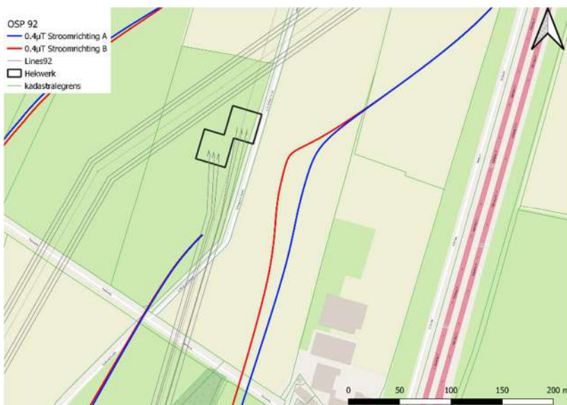
Figuur 24 0,4 μT-contour tijdelijke 150 kV OSP Mast 92
