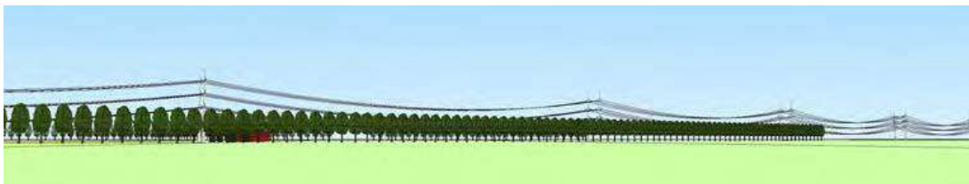
Figuur 8.2 beplanting van bomen met een hoogte van 20m op een afstand van 50m van de lijn. De lijn is zichtbaar boven de beplanting.
