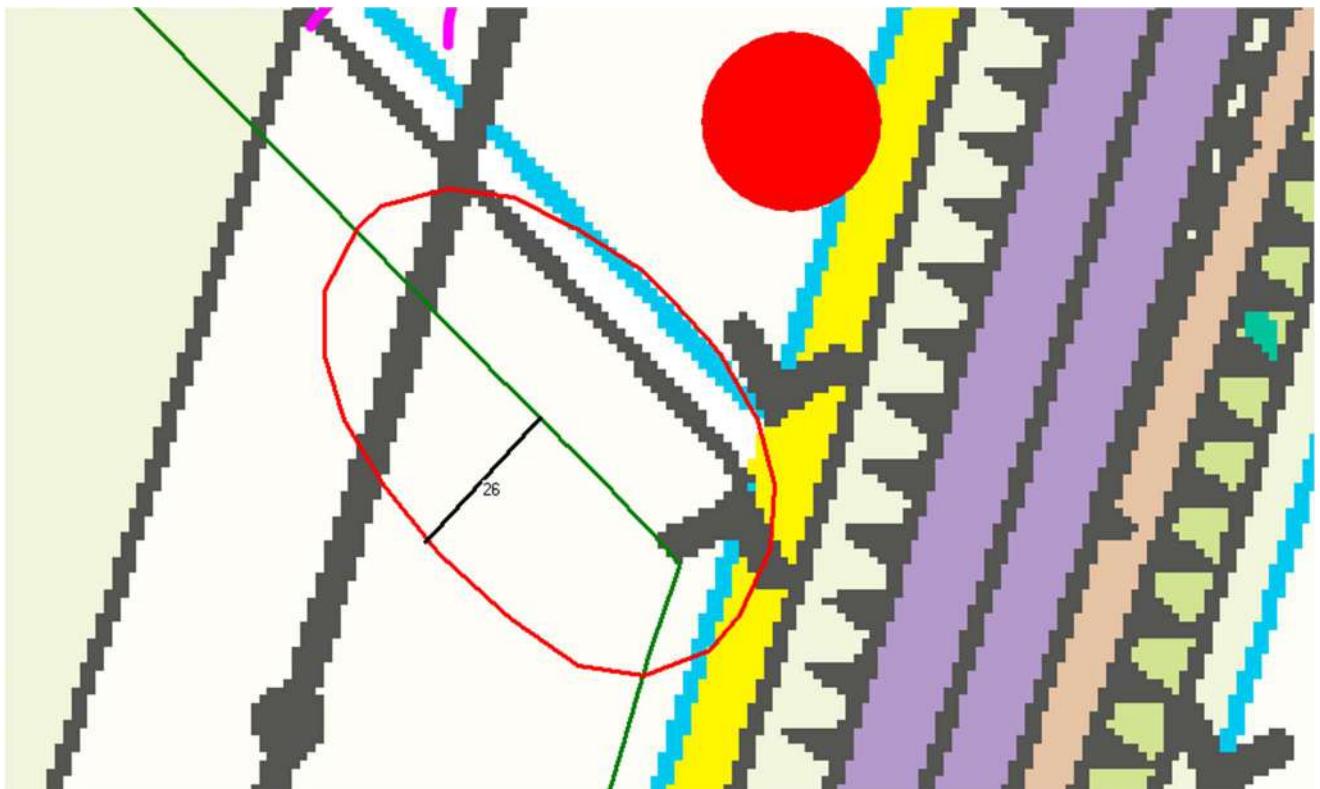
Figuur 19: Uitsnede Carola hogedruk aardgasleiding Z-529-15 en berekende PR10-6 contour (rode omlijning)
