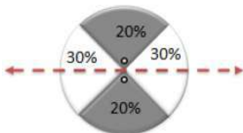
Figuur 4: Valrichtingsverdeling bij het falen hoekmast met rechtdoorgaande lijn ( 0^\circ is in lijnrichting) naar sector
