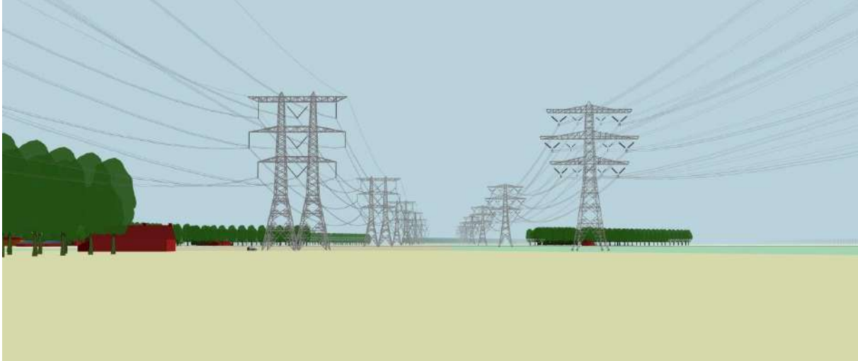
Afbeelding 6a Overzichtstekening met Moldau combimast (rechts) en de bestaande 380kV mast Geertruidenberg-Eindhoven (links)
