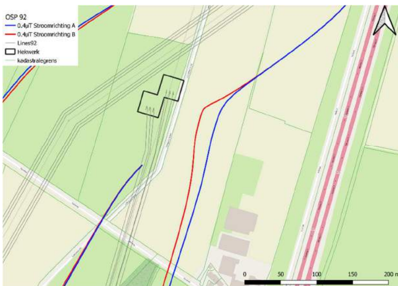
Figuur 24 0,4 μT-contour tijdelijke 150 kV OSP Mast 92
