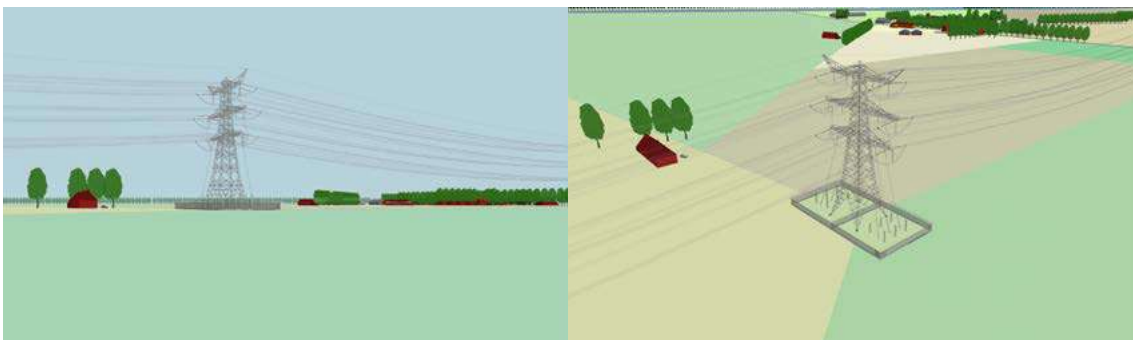
Figuur 3.5 Opstijpunt van de 150 kV-verbinding
