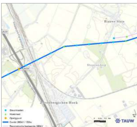
Figuur 5.2. Noordelijk van Zevenbergschen Hoek wordt een doorkruising gerealiseerd met een bestaande lijn van snelweg en rail. Bij Wouwe is goed te zien hoe gecombineerd is met bestaande landschaplijnen zoals de A58.
