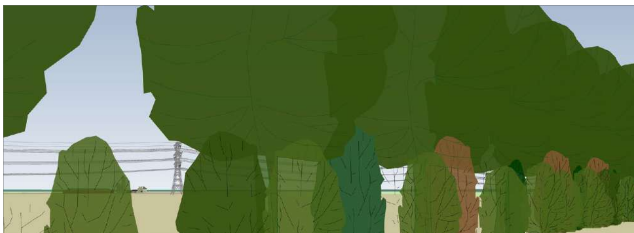
fig. 13 f Beplanting op een afstand van 400m van de verbinding en dicht bij de waarnemer. Struweelbeplanting onder de bomen neemt het zicht op de lijn weg, de aandacht van de weggebruiker zal een andere kant op worden gericht.
