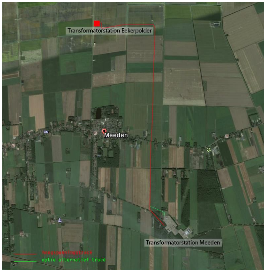
Figuur 1.2 Illustratie globale ligging tracé ondergrondse hoogspanningskabel
