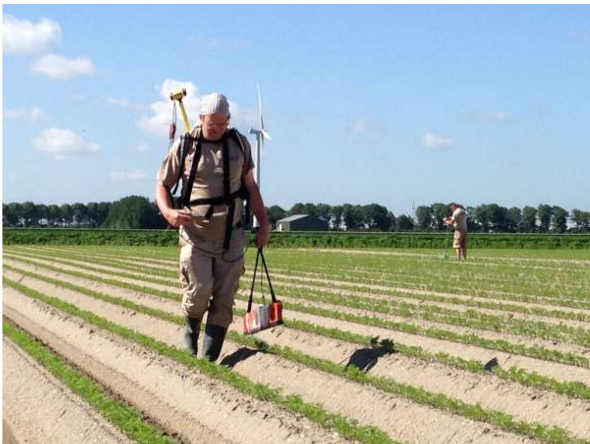
Figuur 2: EM-38 onderzoek op locatie MT02 dat ten tijde van het veldonderzoek begroeid was met wortelplanten
