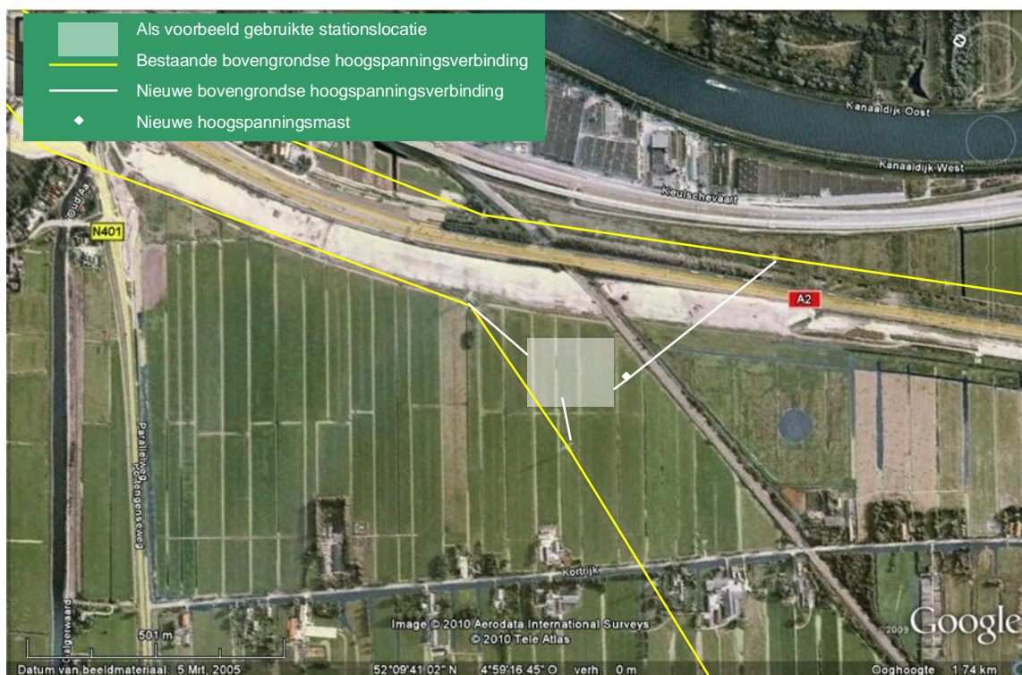
Figuur 11. Locatie-alternatief Kortrijk in zone III. Dit alternatief is ver uitgewerkt, omdat hiervoor eerder al een vrijstellingsprocedure is doorlopen. De 380 kV-lijn komt praktisch over het station. In de driehoek tussen beide spoorlijnen is aan weerszijden van de A2 natuurontwikkeling herkenbaar aan de ruigere begroeiing, met een aangelegd plasje tussen de A2 en de spoorlijn Woerden-Amsterdam. Ondergrond: Google Earth. Let op: de bovenzijde van het beeld is ONO.
