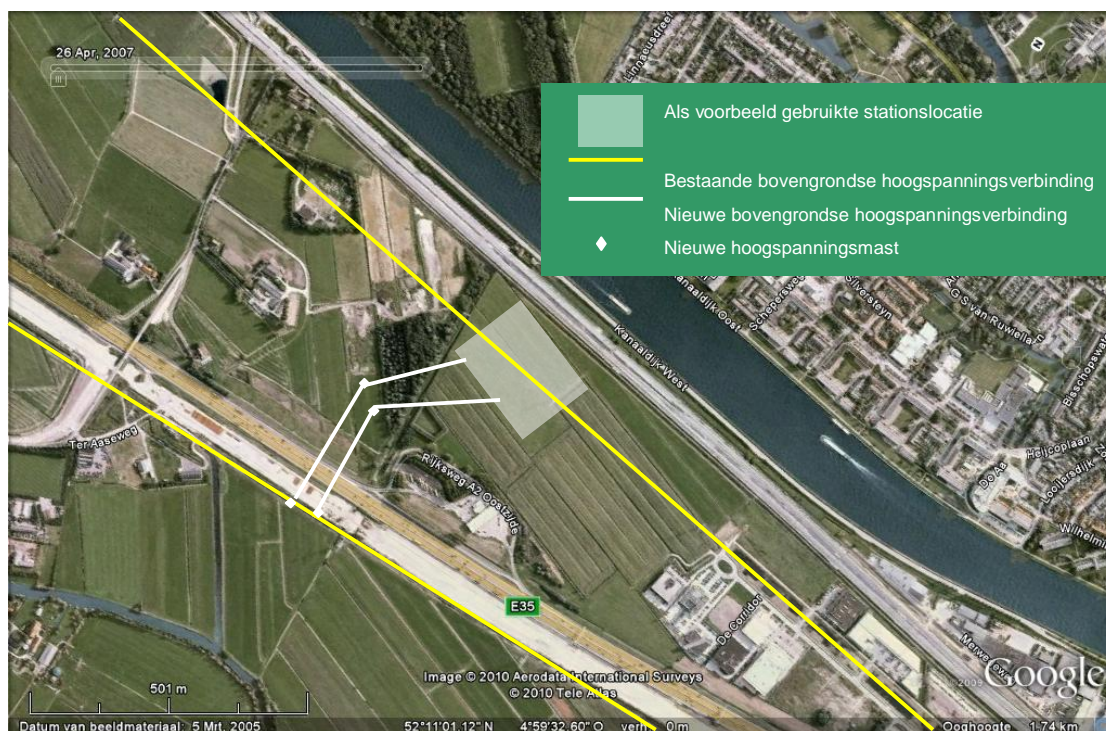
Figuur 13. Locatie-alternatief voor zone VII, Ruwiel. De 150 kV-lijn komt praktisch over het station, maar is nog niet verzwaard. De aansluiting ervan is op deze visualisatie niet uitgewerkt. Vanwege veiligheid is het wellicht niet mogelijk de verbinding met het 380 kV-net over het tankstation te leiden. Daarom is gekozen voor een iets noordelijker aftakpunt. Ondergrond: Google Earth. Let op: de bovenzijde van het beeld is ONO.
