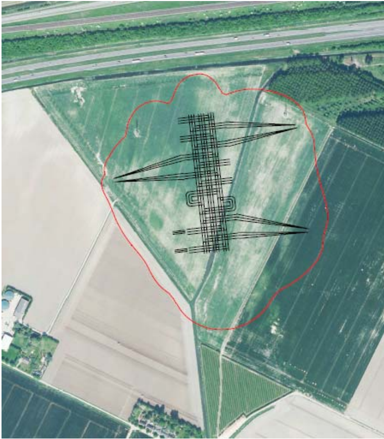
Figuur 2 "Cumulatieve magneetveld" 0,4 microteslacontour van station Rilland (380kV)
