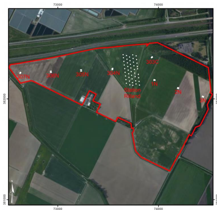
Afbeelding 28 Ligging van de boorpunten binnen het plangebied. Elke mastvoetlocatie is hier met zijn nummer weergegeven. Centraal in het plangebied is de ligging van de boringen voor het Station Rilland weergegeven. Schaal: 1: 25.000. Bron: ESRI – World Imagery 2014
