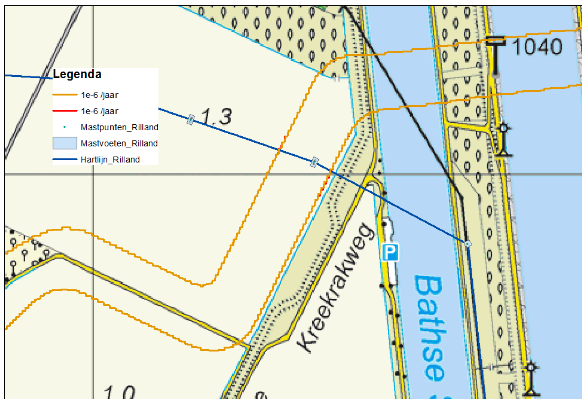
Figuur 10: 10 -6 /jaar-contour in de autonome situatie en de situatie inclusief mast. Nabij de mast is geen sprake van een significante wijziging van de 10 -6 /jaar-contour.
