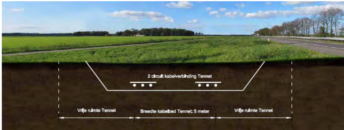
Figuur 2.6 Verbeelding van de ondergrondse 150 kV-verbindingen.
