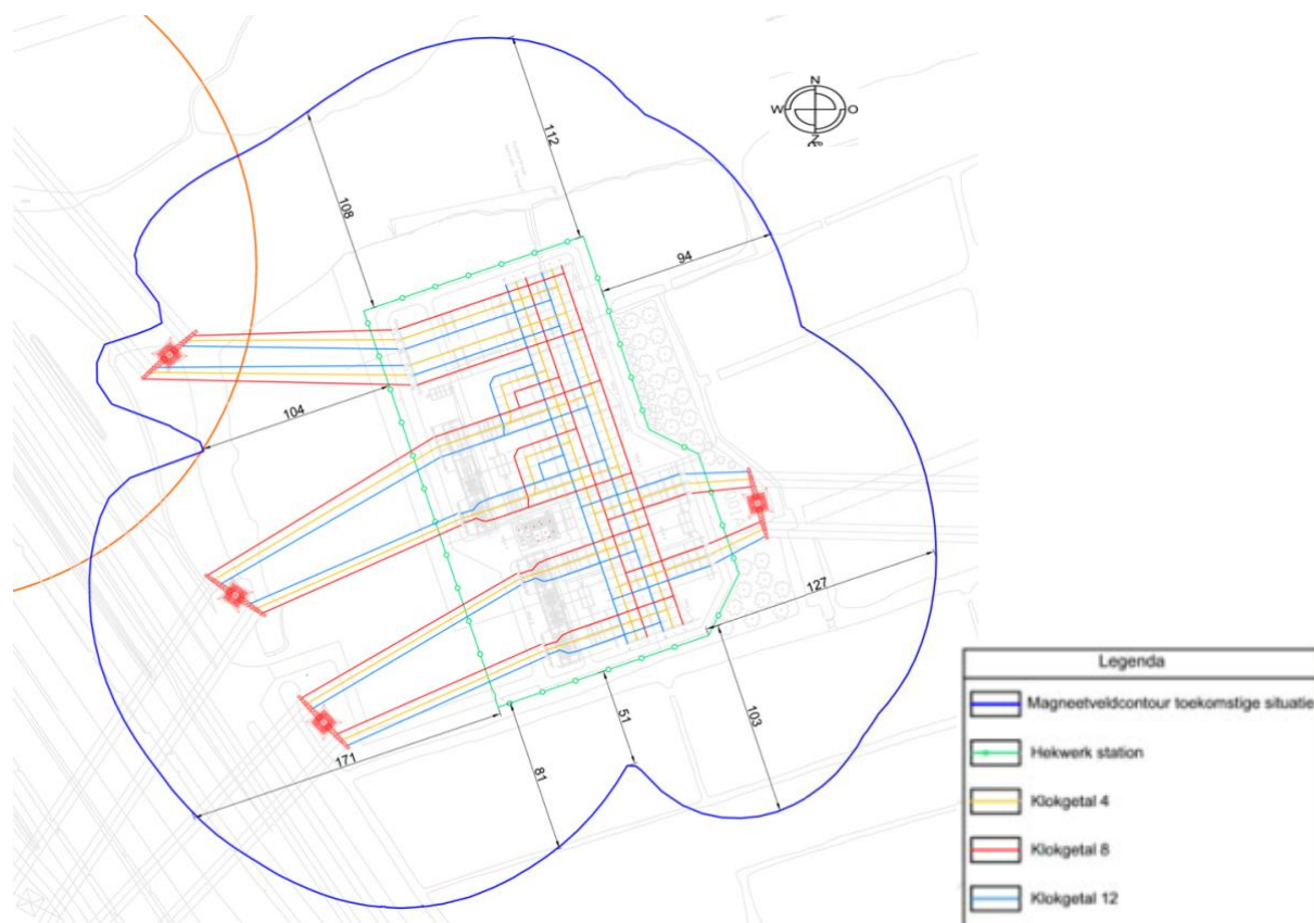
Figuur 5.1 Magneetveldcontouren 380/150 kV transformatorstation Oostzaan
