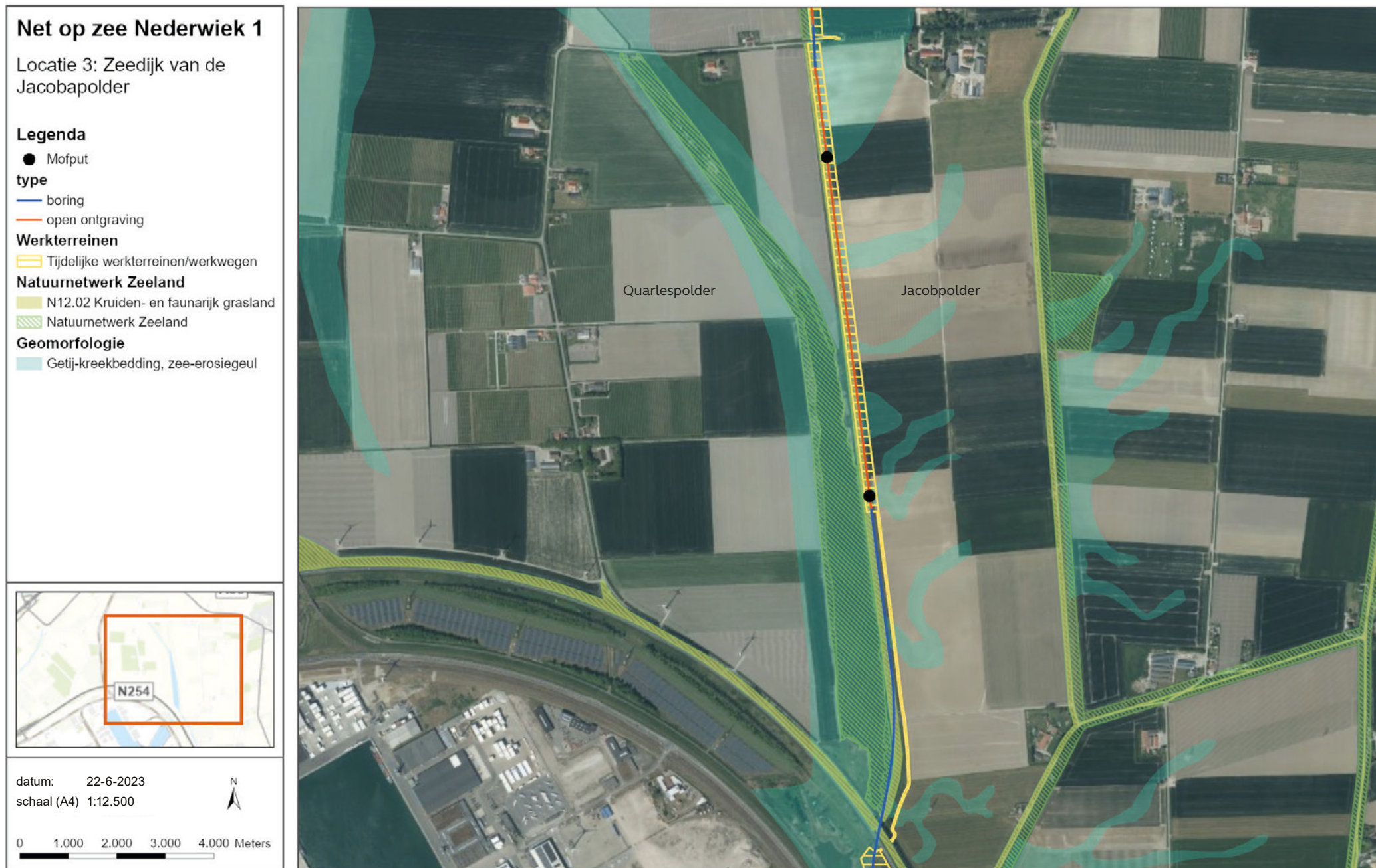
Figuur 13 Locatie 3: overzicht tracé en tijdelijke werkterreinen Zeedijk van de Jacobapolder
