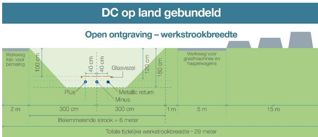
Figuur 2.9: Werkstrookbreedte bij open ontgraving op land
