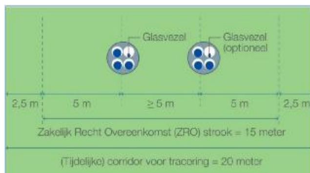
Figuur 2.9. Boring 380kV-wisselstroomkabels op land
