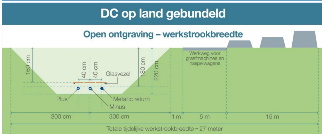
Figuur 3-8 Schematische weergave van de werkstrookbreedte DC op land
