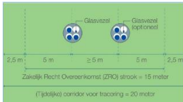
Figuur 2.9. Boring 380kV-wisselstroomkabels op land
