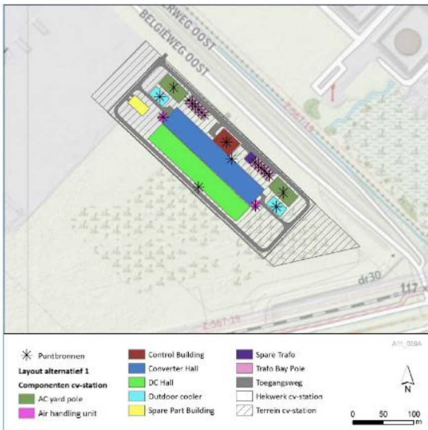
Figuur 5.16. Geluidbronnen converterstation Borssele
