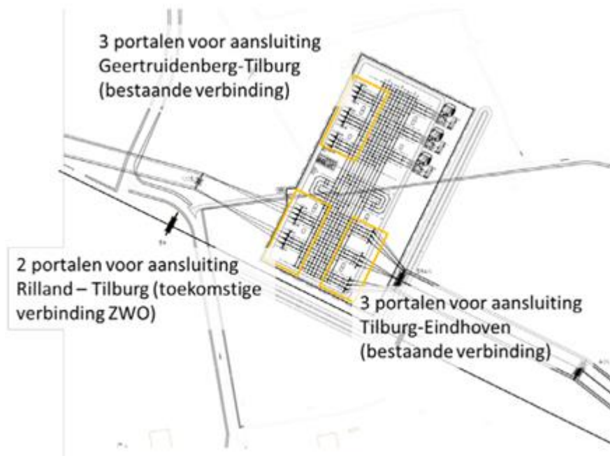
Figuur 2.4 Aansluitportalen 380 kV-hoogspanningsstation
