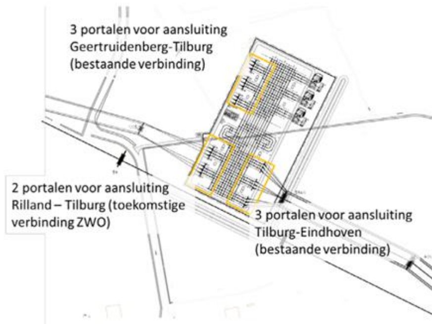
Figuur 2.4 Aansluitportalen 380 kV-hoogspanningsstation
