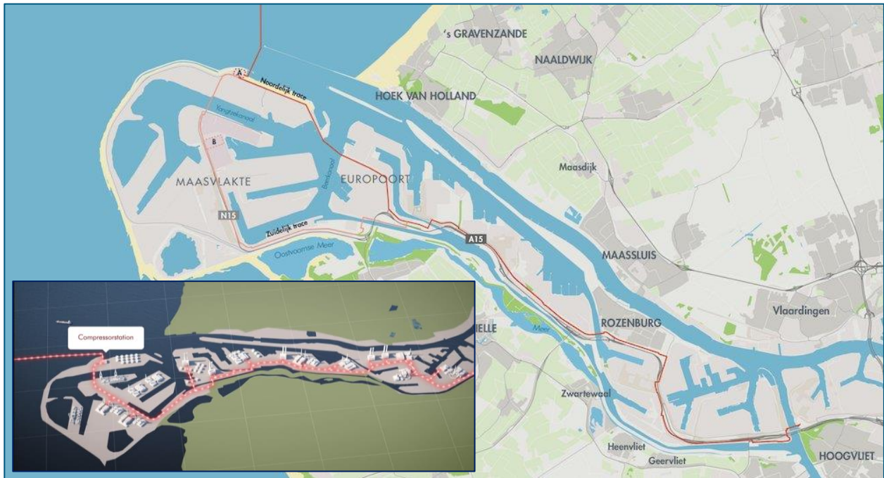
Figuur 2-2: Schematische weergave van de (geplande) ligging van transportleiding (verzamel-buisleiding) voor CO 2 in het havengebied, voor het afgevangen CO 2 van leveranciers. Inzet: schematische verbeelding van de transportleiding op land naar het compressorstation.
