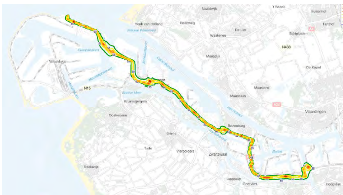
Figuur 8.2 contouren van gelijke geluidbelasting voor het noordelijke tracé
