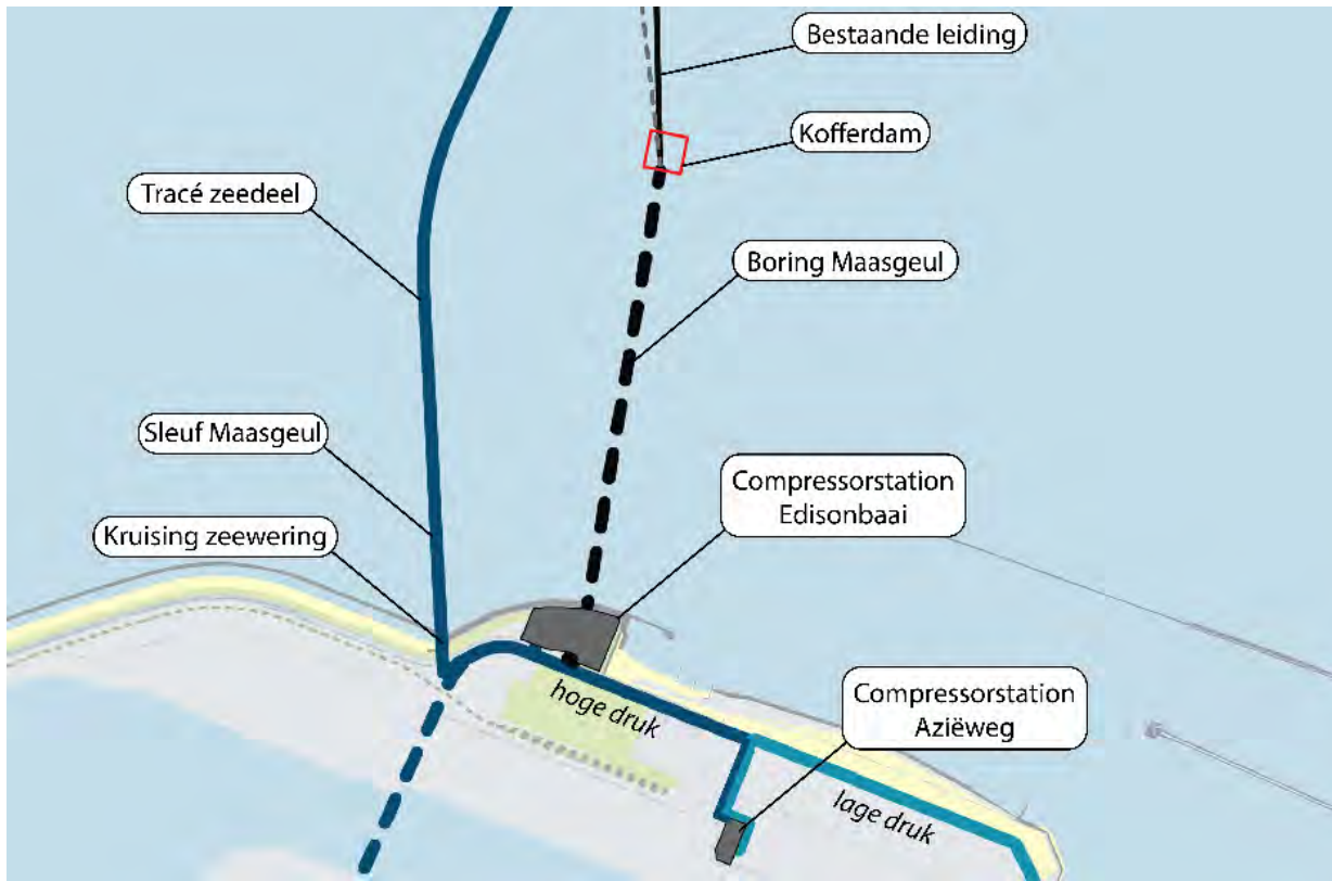
Figuur 4.1 Overzicht varianten voor de kruising Maasgeul
