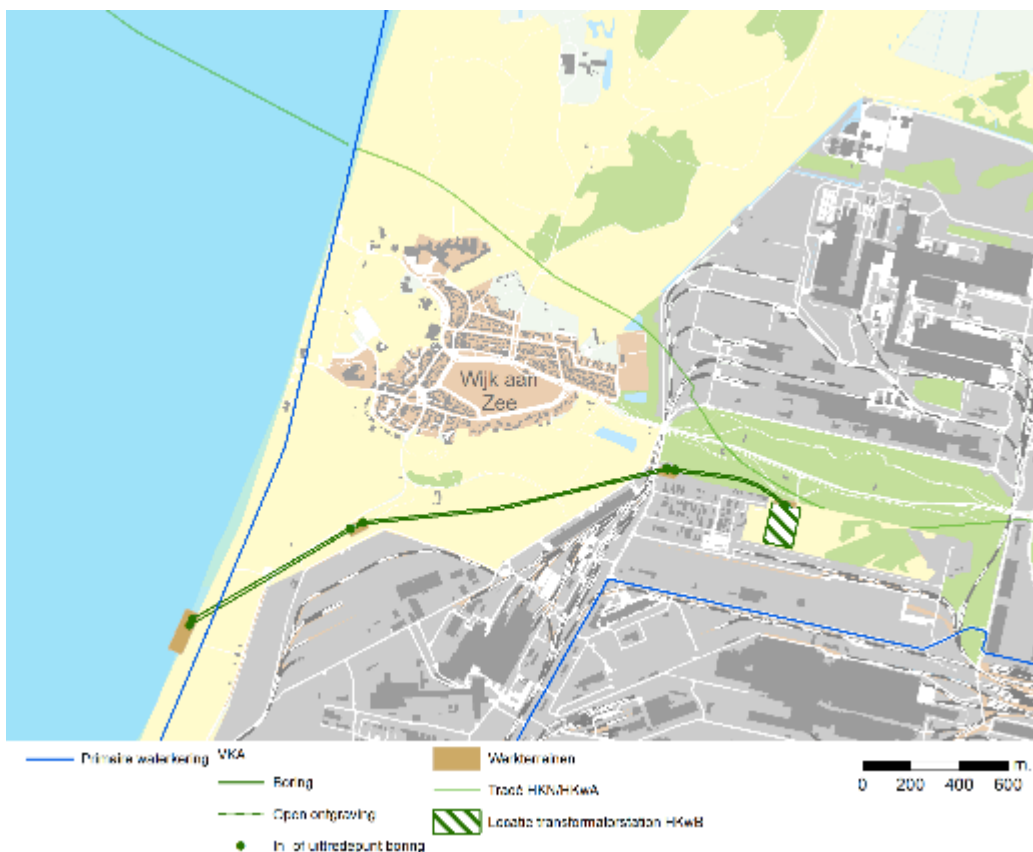
Figuur 5.11: Kabeltracé op land en primaire waterkering
