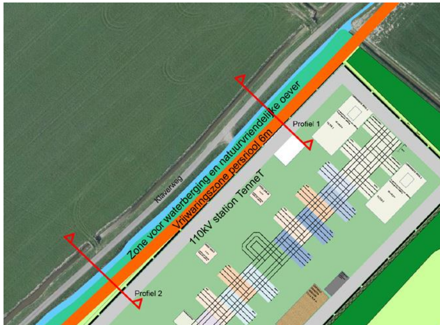
Afbeelding 5.7 Verbreding watergang en aanleg natuurvriendelijke oever
