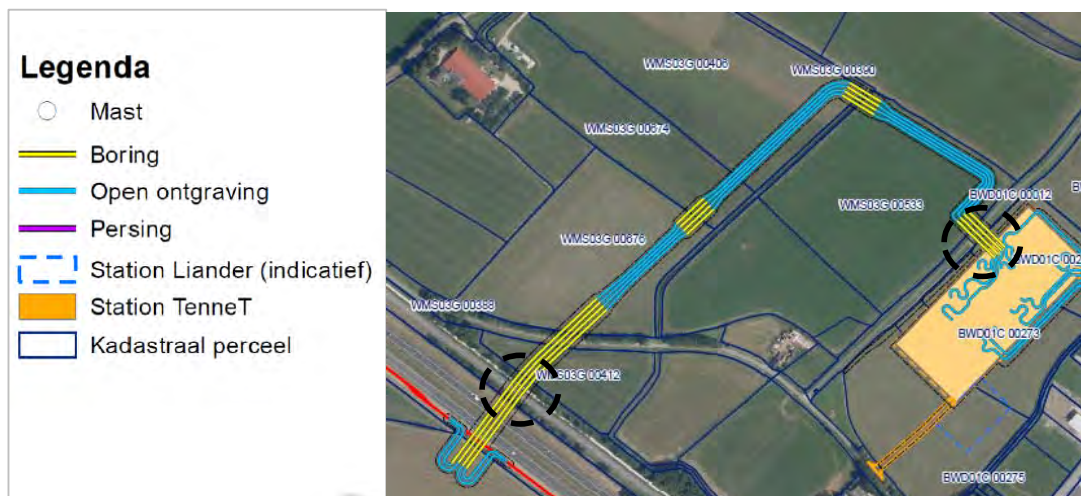
Figuur 4.3 Kruising ondergrondse kabelverbinding met persleidingen (bron: Ruimtelijke en (net)technische uitgangspunten t.b.v. het nieuwe 110 kV-hoogspanningsstation en de hiervoor benodigde kabelcircuits in westelijk Friesland (Bolsward 110) d.d. 2 april 2020)
