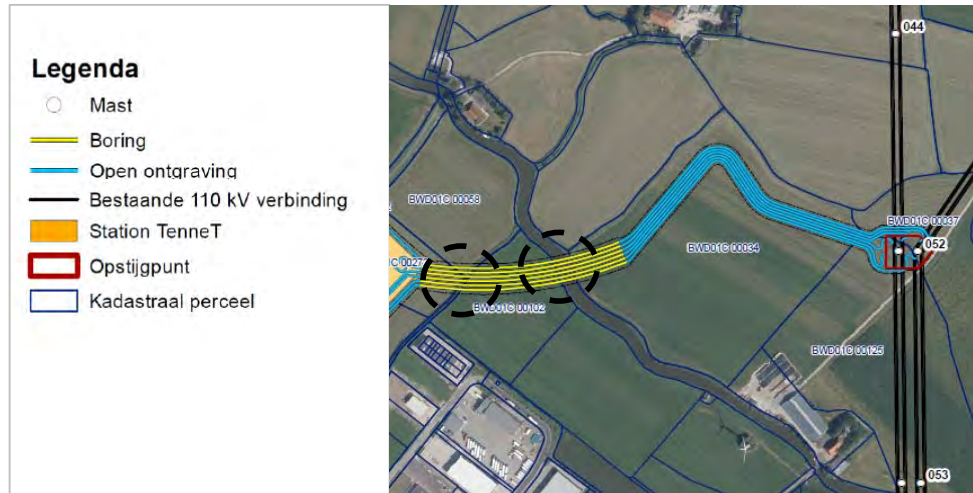
Figuur 4.2 Kruisingen kabeltracé met beschermingszones en watergangen (bron: Ruimtelijke en (net)technische uitgangspunten t.b.v. het nieuwe 110 kV-hoogspanningsstation en de hiervoor benodigde kabelcircuits in westelijk Friesland (Bolsward 110) d.d. 2 april 2020)
