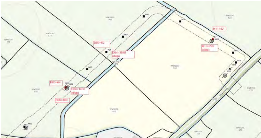
Figuur 6.2 Chlorideconcentraties freatische en diepe (diep) peilbuizen in mg/liter west van hoogspanningsstation en hoogspanningsstation
