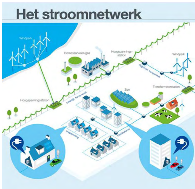
Afbeelding 1.3 Schematische weergave van het stroomnetwerk (bron: TenneT)
