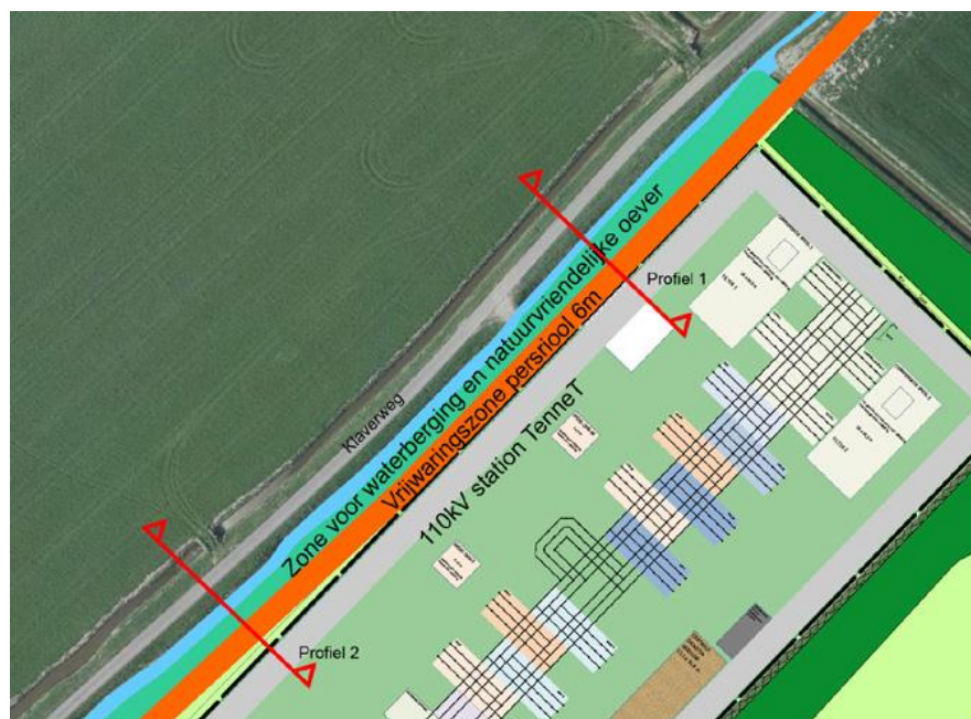
Afbeelding 5.7 Verbreding watergang en aanleg natuurvriendelijke oever
