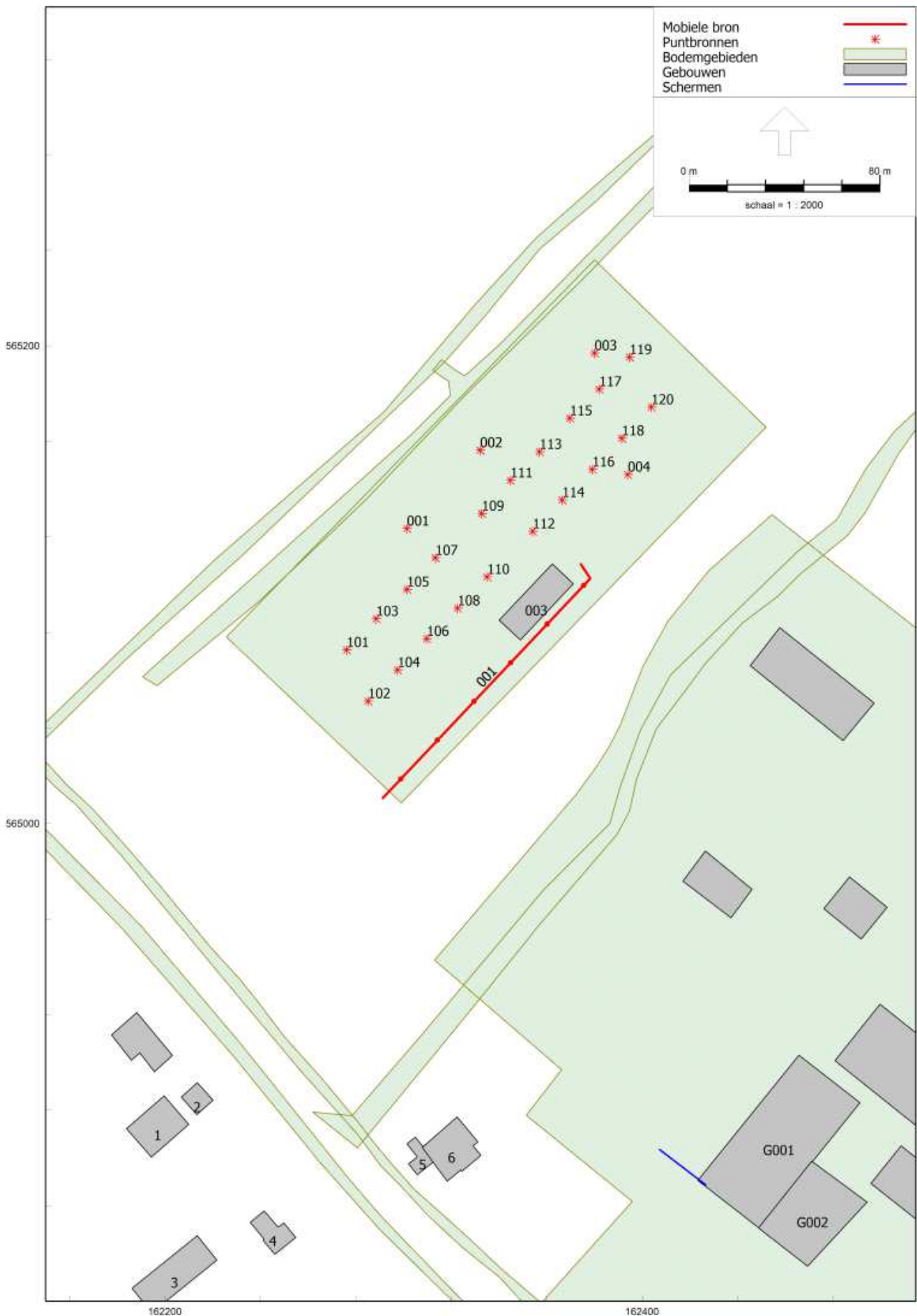
Figuur 1.2 Invoerplot rekenmodel – bronnen en objecten 110 kV-station
