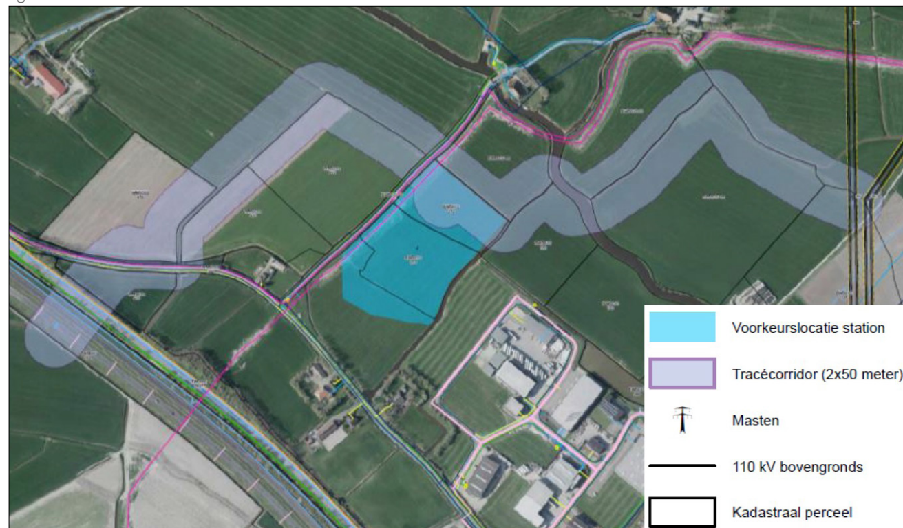
fig. I Locatie station Bolsward met kabeltracés
