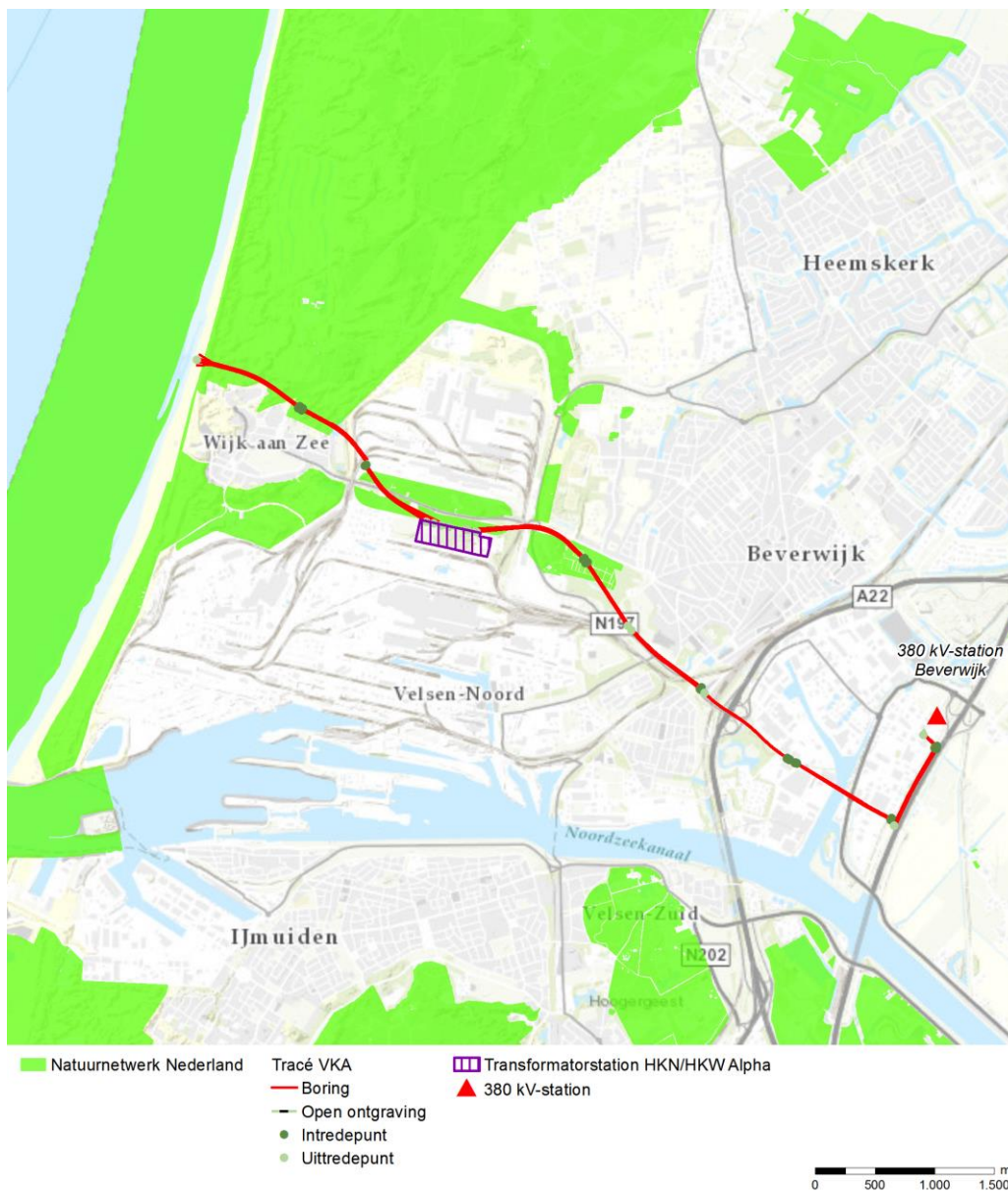
Figuur 13: Hoogspanningskabels op land en begrenzing NNN
