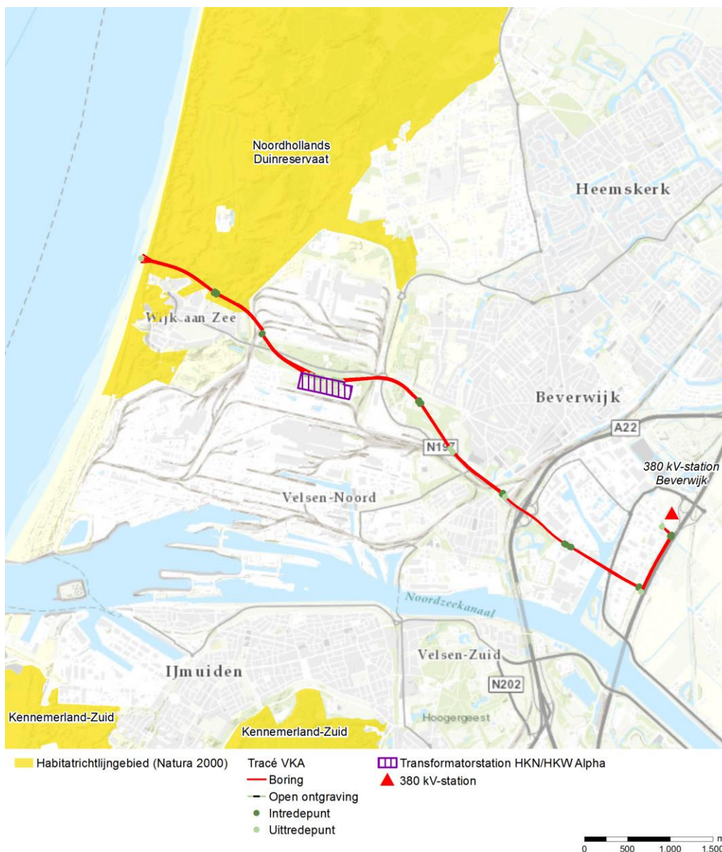
Figuur 12: Hoogspanningskabels op land t.o.v. N2000-gebieden
