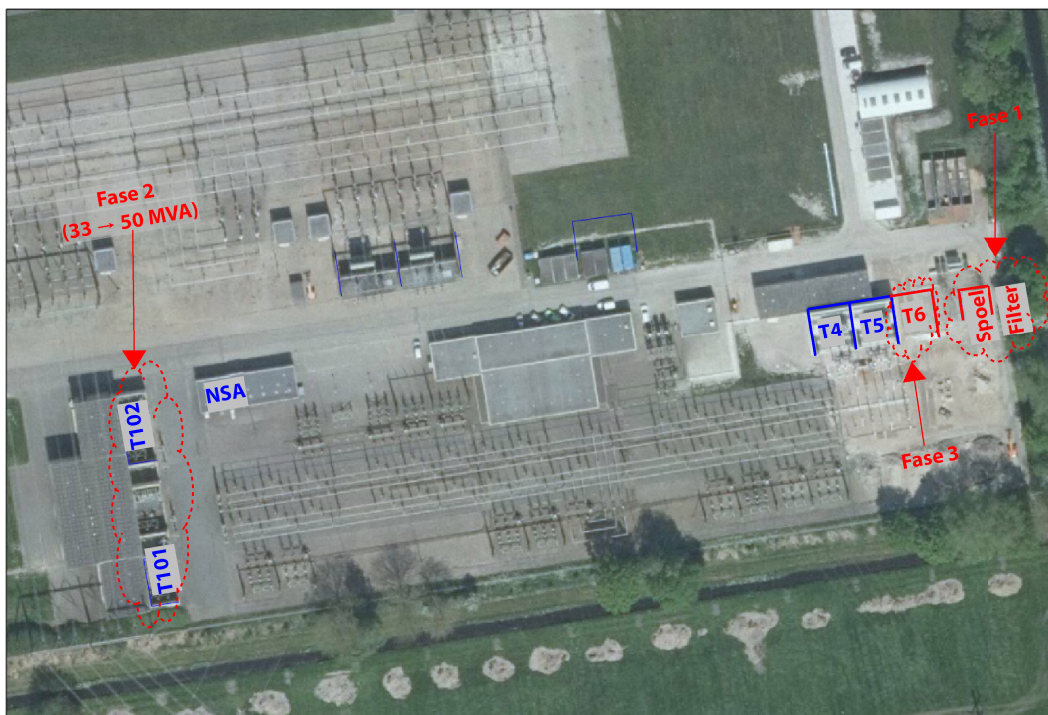
f2.2 Globale lay-out van het transformatorstation van Liander inclusief de fasering van de voorgenomen uitbreidingen/wijzigingen
