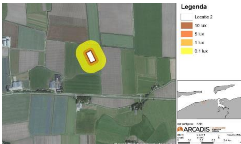
Figuur 5.32 Verlichtingssterkte aanlegfase productielocatie (bron: MER Gaswinning en gasboring Ternaard)
