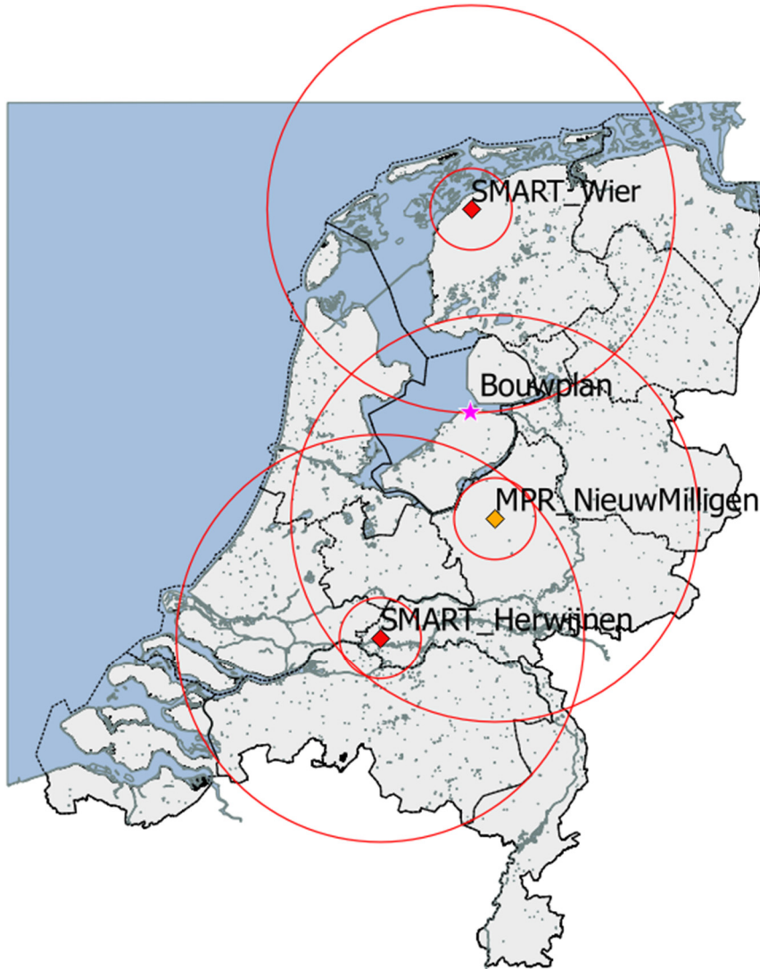
Figuur 4. Locaties van de nieuwe SMART-L EWC GB gevechtsleidingsradars (rode ruit) en de bestaande MPR (oranje ruit) met daaromheen de 15 en 75 km cirkels. De donkergrijze vlakken zijn de in de AHN-1 gedefinieerde stedelijke gebieden. De ligging van het te toetsen bouwplan is aangegeven met een roze ster.
