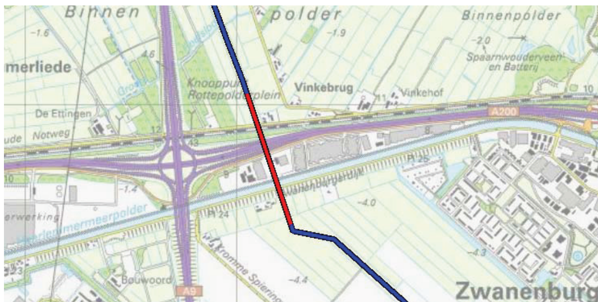
Figuur 5 Het gedeelte van leiding A-803 (rood) met een gronddekking van meer dan 7 meter, vanaf waar bij de Ringvaart van de Haarlemmermeerpolder vliegtuigen als faaloorzaak van de leiding worden uitgesloten. Dit deel van de leiding loopt van Rijksdriehoekcoördinaten (RD) X:109058 Y: 489017 t/m X: 109251 Y: 488442. Dit komt overeen met stationing 13210 t/m 13840 van het tracé Beverwijk- Wijngaarden.
