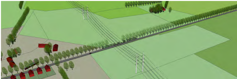
Fig. 3.2.2b: Beperking van de hoogte van bomen door snoei van de kruin. Het ritme van de stammen blijft gehandhaafd. Door een mast nabij de laanbeplanting te situeren kan de noodzakelijke snoei beperkt blijven.
