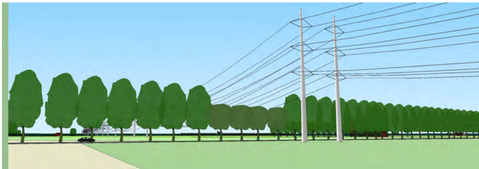
Fig. 3.2.2b: Beperking van de hoogte van bomen door snoei van de kruin. Het ritme van de stammen blijft gehandhaafd. Door een mast nabij de laanbeplanting te situeren kan de noodzakelijke snoei beperkt blijven.
