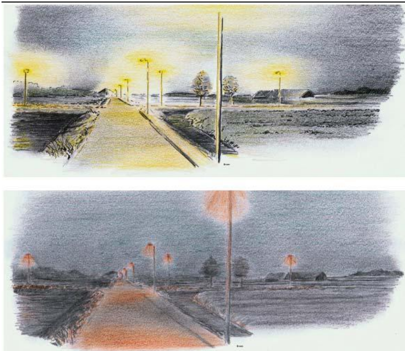
Figuur 3.17 Een voorbeeld van verschil in verlichting. De onderste schets geeft een wenselijke situatie voor vleurmuizen; afgeschermd armaturen en het gebruik van amberkleurige verlichting.
