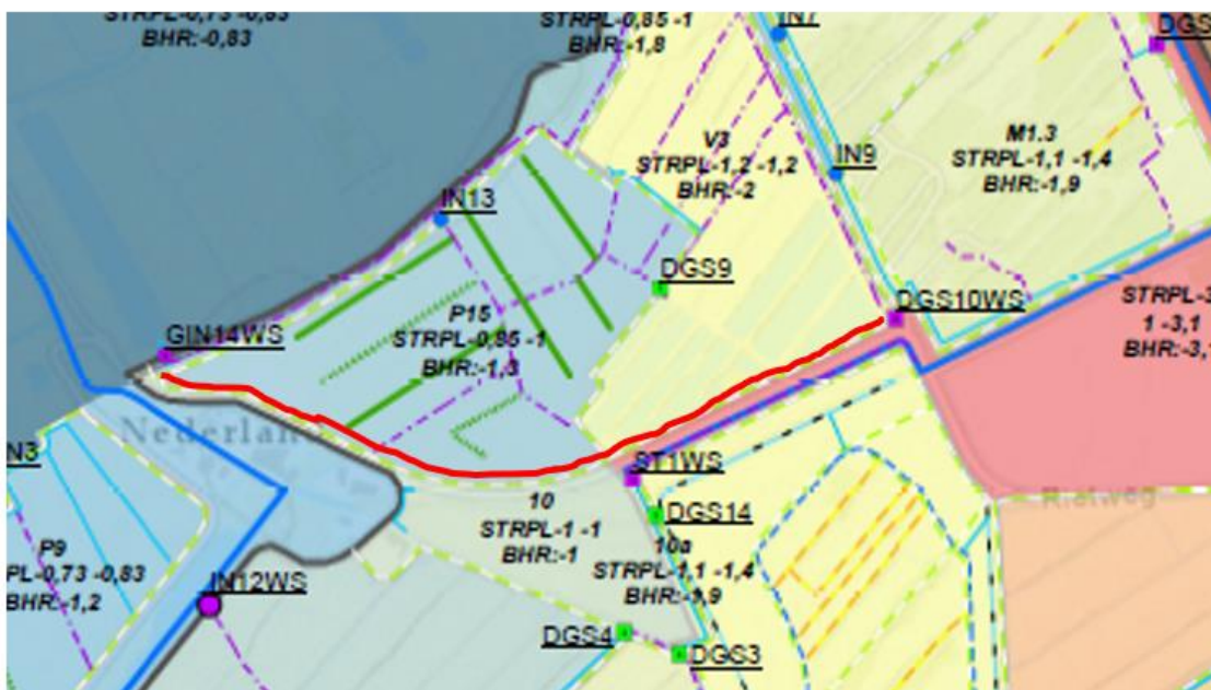
Figuur 11: De bermsloot (rode lijn) waarvoor in het ontwerp een peil van -1.5 m NAP wordt gehanteerd
