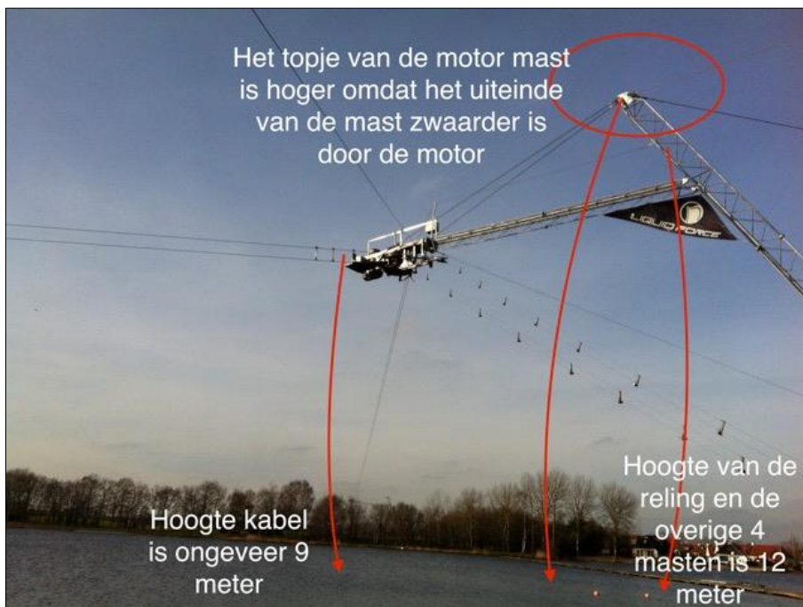
Figuur 5. De startmast is hoger omdat daar de electromotor aan hangt (let op de rode lijnen geven slechts de maathoogten aan)
