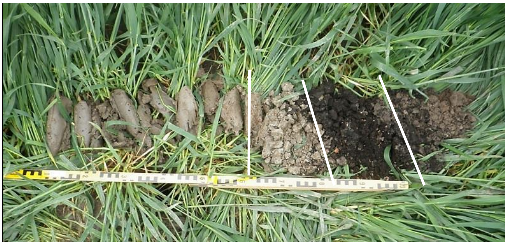
Afbeelding 4a. Beeld van boring 249 met links naar rechts het kleidek, de siltige laag met puin, veen en dekzand
