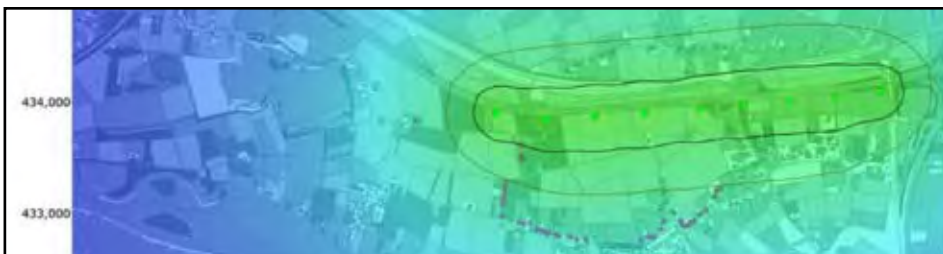
figuur 37: geluidbelasting ten gevolge van de windturbines langs de Grift (Nijmegen) en op het Betuws Bedrijvenpark. L-etmaal contouren na WNC correctie (-4,4 dB(A)). Groen=45 dB(A)-contour, zwart=50 dB(A)-contour (voorkeur). [2]
