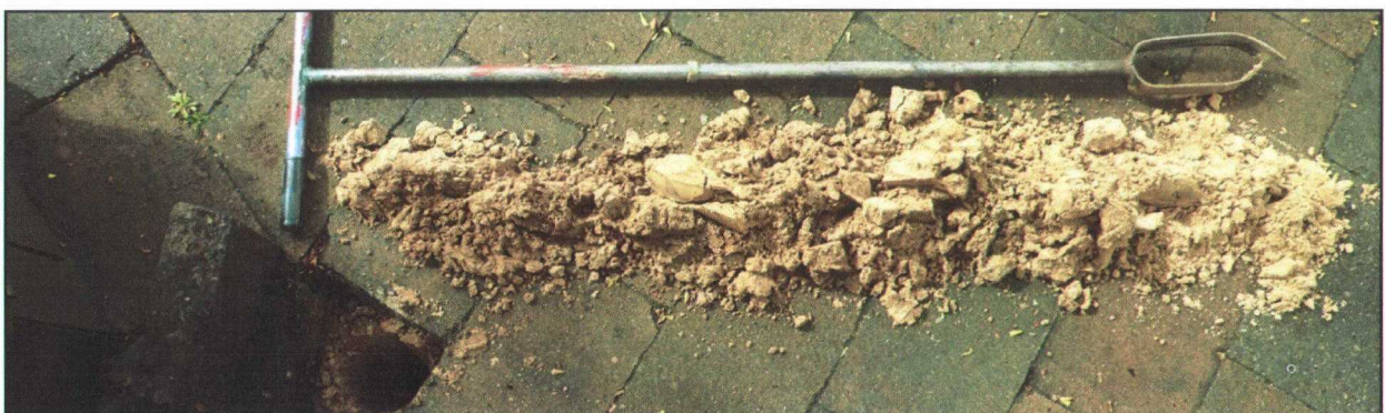
Foto 6: grondboring buiten plantvak
