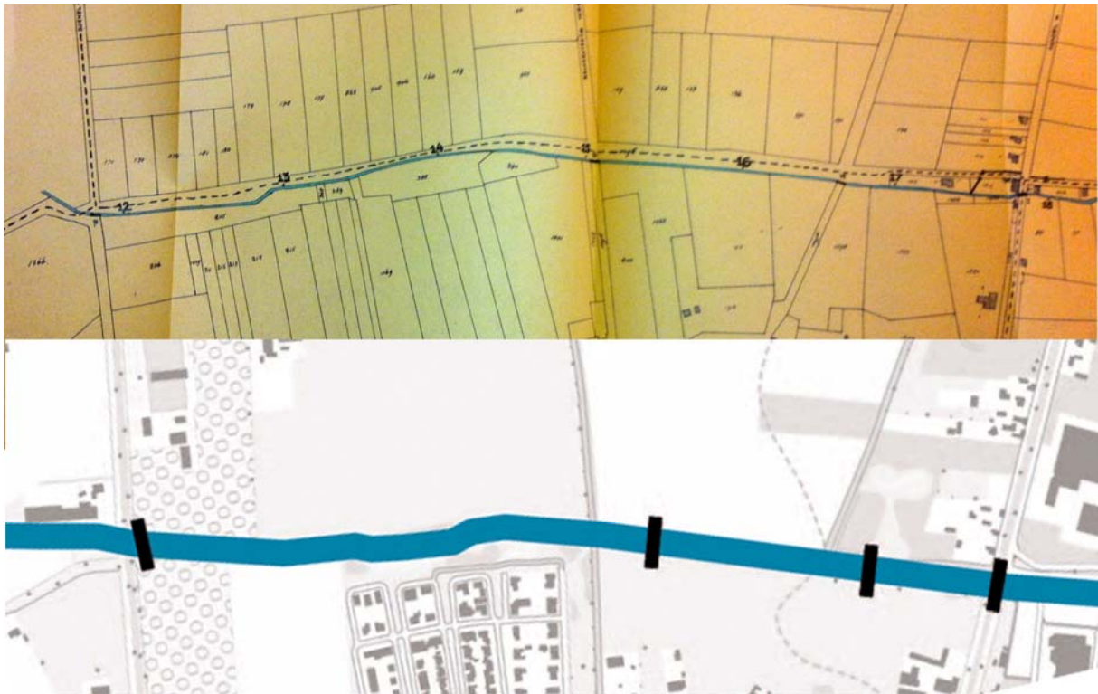
Figuur 4.1.3. Vergelijking historisch lengteprofiel (leggerkaart 1948) met het huidige profiel ter hoogte van traject II.
