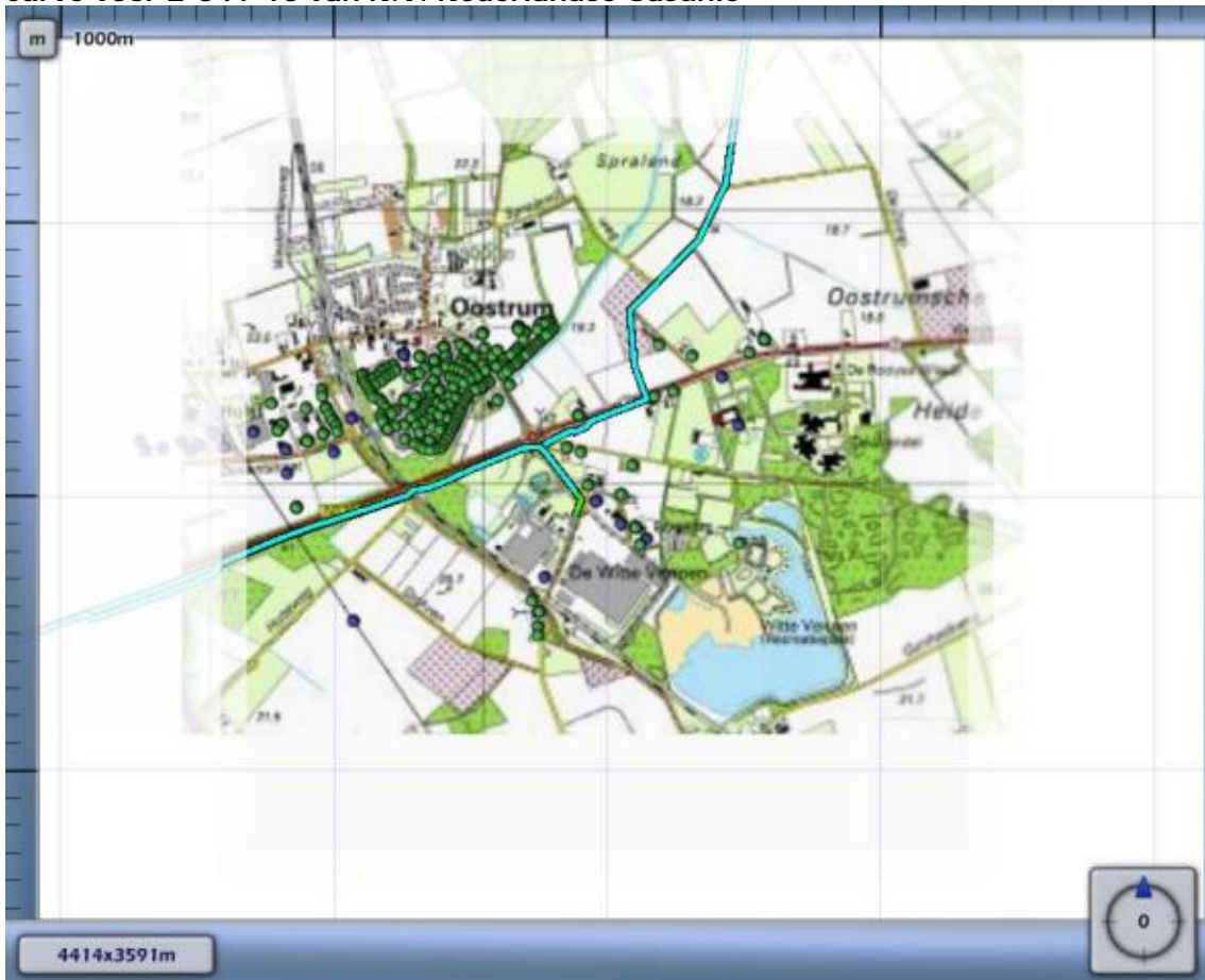
Figuur 4.3 Kilometer leiding behorende bij de maximale overschrijding van de FN-curve voor Z-541-10 van N.V. Nederlandse Gasunie
