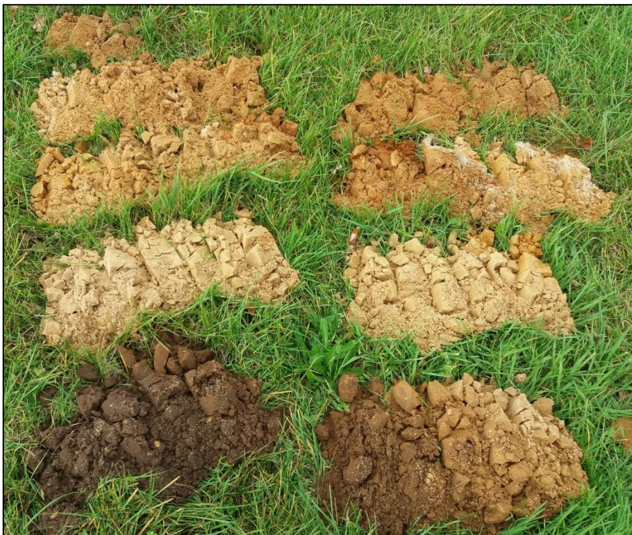
Afbeelding 3: Foto profielboring A van links onder naar boven per 0,5 meter uitgelegd
