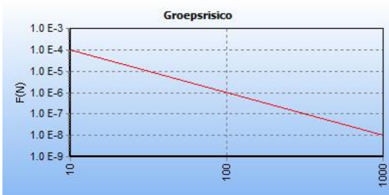
5.1 Figuur 5.2 FN curve voor 5017_leiding-A-530-06-deel-1 van N.V. Nederlandse Gasunie voor de kilometer tussen stationing 0.00 en stationing 1000.00
