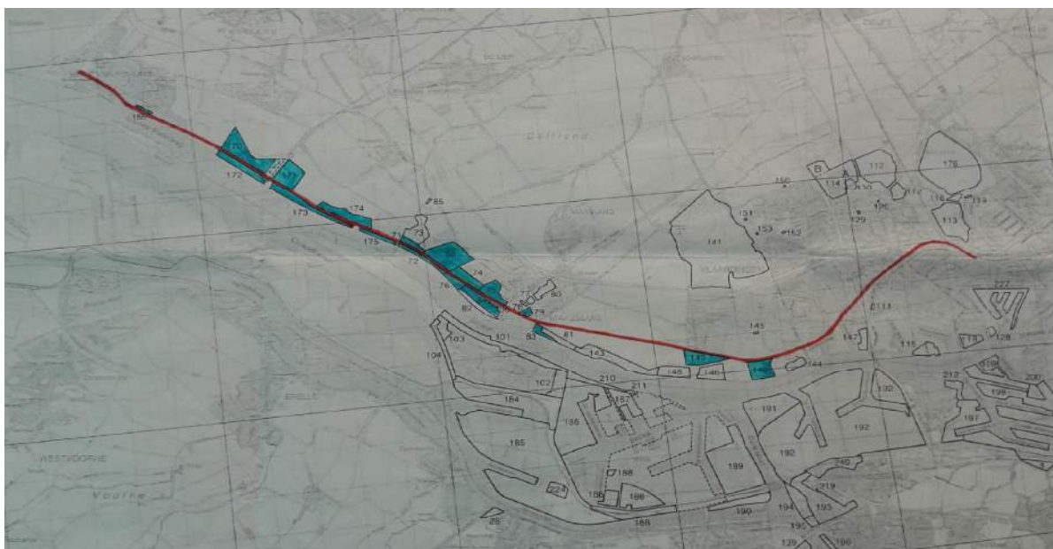
Figuur 2.1 Overzicht baggerloswallen langs het gebied rondom de spoorlijn en het gebied ter plaatse van de verlenging. Toelichting bij kaart baggerloswallen: In blauw is aangegeven waar de loswallen zich bevinden t.o.v. Hoekse Lijn (rood)
